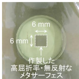
(a) 高屈折率・無反射なメタサーフェスの全体写真
